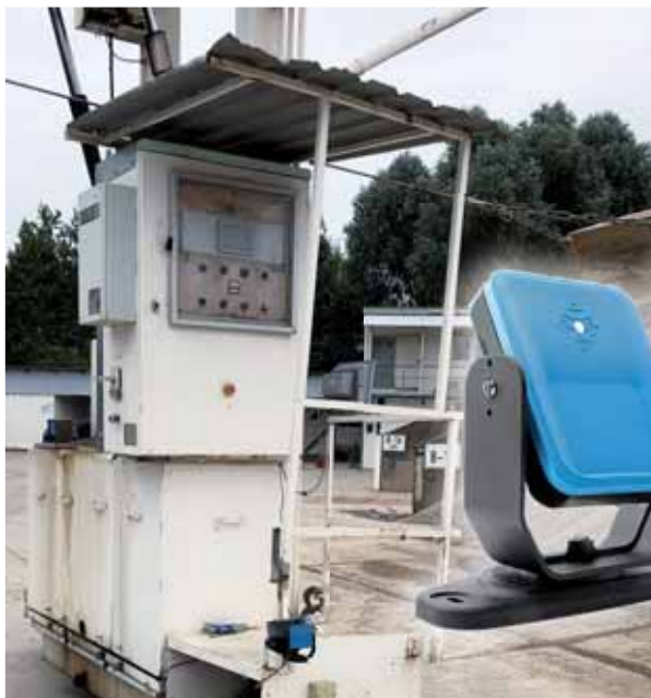
Fahrwegabsicherung im Kieswerk durch Sicherheits-Radarsensoren Type Serie 100/200
